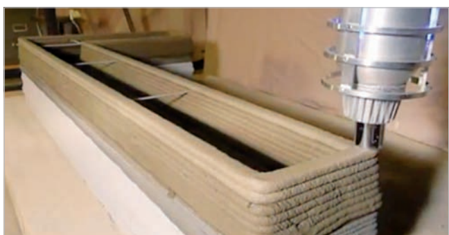
Obr. 6 3D tlač z betónu
