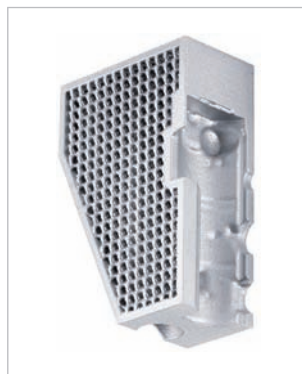
Technologická výhoda: kovové prsty SCHUNK eGRIP disponujú integrovanou dutou alebo mriežkovou štruktúrou, ktorá umožňuje zníženie hmotnosti o 10 až 50 %.
