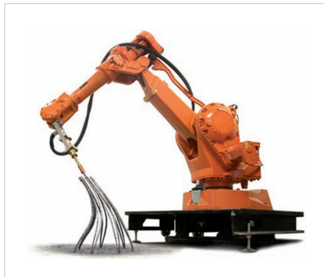
Obr. 4 3D tlač kovových konštrukcií
